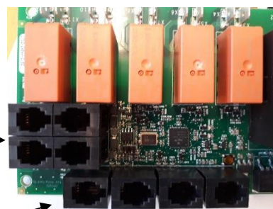
Afbeelding 4 . Volgorde van RJ10-stekkers. Sensor, deurschakelaar, afstandsbediening, extra NTC
