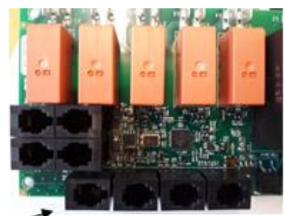
Imagen 4 Orden de los conectores RJ 10. Sensor, interruptor de puerta, control remoto, NTC adicional
