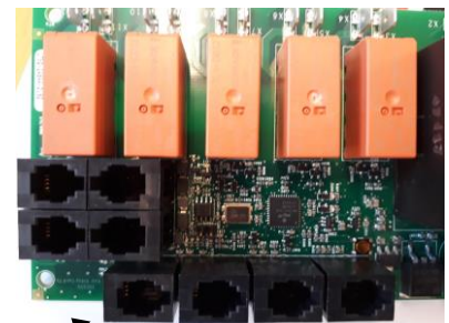
Figure 8 . Ordre des connecteurs RJ 10. Capteur, interrupteur de porte, télécommande, capteur NTC supplémentaire.
