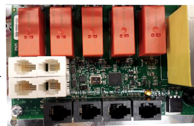
Figura 5 . Ordine dei connettori RJ 10. Sensore, interruttore porta, controllo remoto, NTC aggiuntivo
