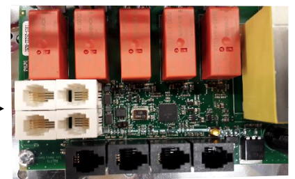
Рис 5 Расположение разъемов RJ 10. Датчик, дверной выключатель, дистанционное управление, дополнительный датчик NTC
