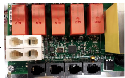
Abbildung 5 Reihenfolge der RJ 10-Anschlüsse. Sensor, Türschalter, Fernbedienung, zusätzlicher NTC
