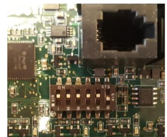
Abbildung 4 DIP-Schalterstellungen für den Betrieb eines Saunaheizgerät.
